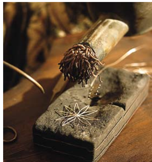
L'oggetto da saldare veniva posto su di un pezzo di carbone di ciliegio, che diffondeva uniformemente il calore.
